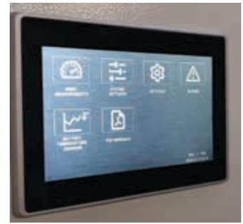
L'HMI/PLC XV300 offre una grafica avanzata e permette di caricare le operazioni molto velocemente, anche quando le pagine sono molto dettagliate.
